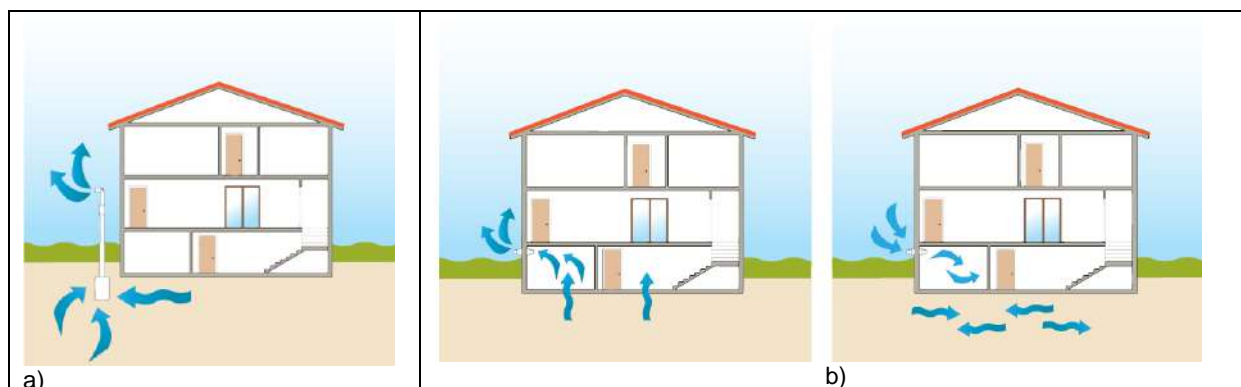
Figura 4.18: esempi di interventi di risanamento/prevenzione di tipo attivo. a) pozzetto di drenaggio radon esterno all'edificio; b) ventilazione meccanica degli interrati/seminterrati (Fonte: opuscolo di convegno "Abitare sostenibile e rischio radon". Nuoro 21.10.2019)
